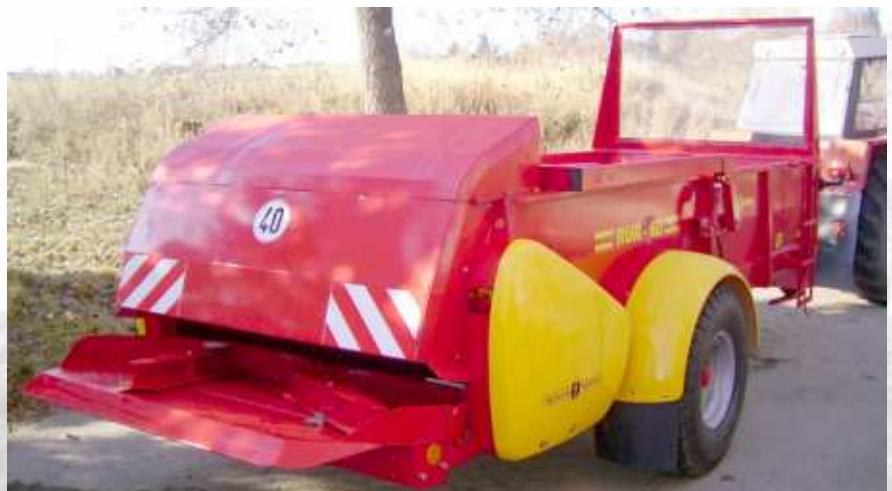
Rozmetací stůl je dvoulopatkový s efektivním rozhozem 14 metrů. Standardně je stroj vybaven mechanickým pohonem řetězových dopravníků. Na přání je možné stroj vybavit hydraulickým posunem dna a dále hydraulickým zadním čelem, které umožňuje přepravu a rozmetání kašovitých materiálů.
