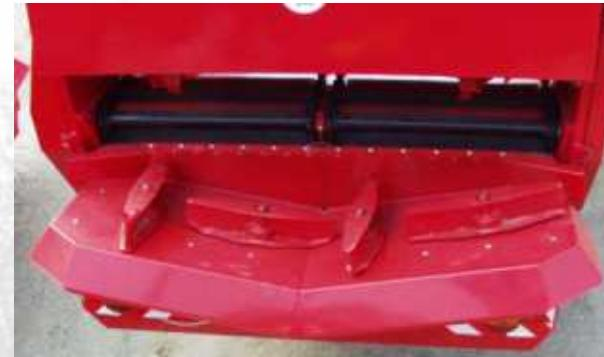
Korba je standardně opatřena dvojitým podlahovým dopravníkem se čtyřmi vysoko pevnostními řetězy. Pohon je řešen hydraulicky, kde je zajištěna komfortní obsluha s kabiny traktoru, změnu dávky a směru pohybu lze provést plynule pomocí regulačního ventilu. Jištění posunu dna zabezpečuje přepouštěcí ventil.
