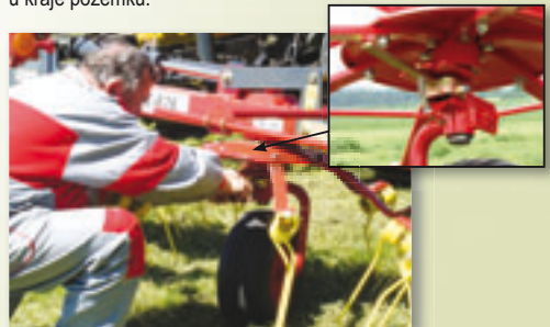
Pojezdová kola lze natočit pro dosažení bočního odhozu.
