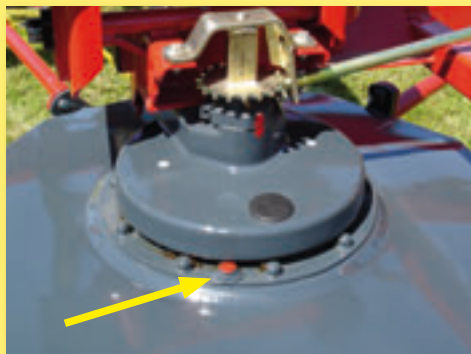
Zátka s měrkou pro kontrolu množství oleje v kulisovém mechanismu.
