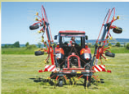
Rozkládání stroje - odjištění aretace.
